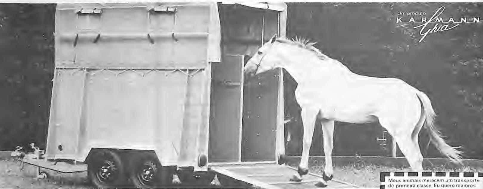
O trailer Karmann-Caravan mod. 1802-AD foi especialmente projetado para transportar animais de porte com comodidade e segurança. Possui laterais internas acolchoadas, piso de borracha sintética, tampa traseira basculante servindo de rampa de acesso, teto de lona facilmente removível, janelas de plástico, ventanas, e suspensão independente nas quatro rodas, garantindo um transporte suave em qualquer terreno.
